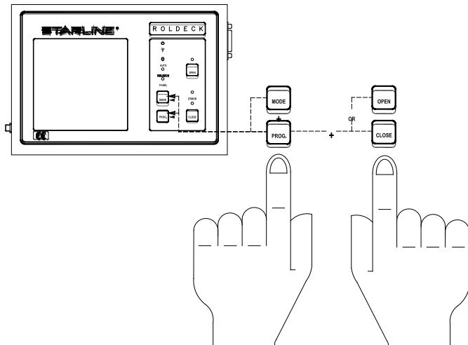
Open de programmering door toets „**prog**“ + „**mode**“ en de toets „**open**“ of „**close**“ gelijktijdig in te drukken.
